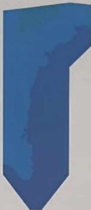
3.11 – сурет - КВТК-100-150 қазандығының тік бөліміндегі азот тотығының түзілу өрісі
