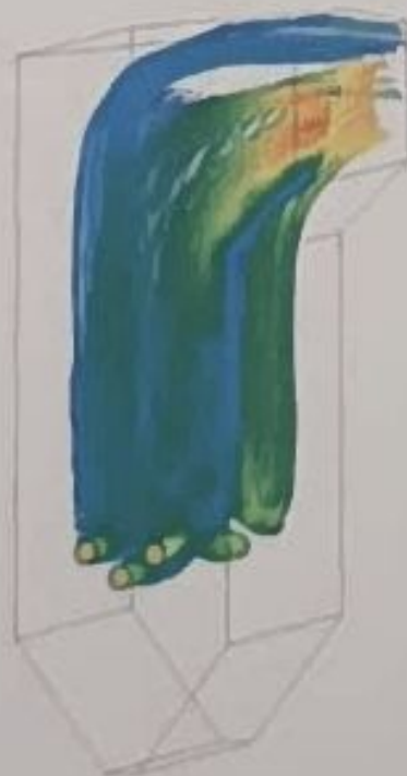
3.12 – сурет - КВТК-100-150 қазандық қондырғысының ошағындағы газдардың қозғалыс жолдары
